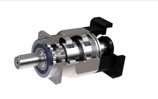
LIMING遊星減速機の高剛性・高精度を実現する特長の出力時とキャリヤの一体構造やケースと内歯車一体構造に加え、出力側ベアリングを円錐ころ軸受の対向支持方式としています。
