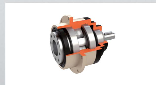
入力軸はサーボモータ軸を付属のコレットでノンバックラッシ締結する入力方法の他、SDDでは中実入力軸とし、ブーリやカップリングを介した入力も可能です。
